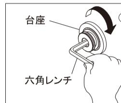
②台座を壁面内のネジ部にねじ込み、「六角レンチ」(対辺10ミリ)で壁面にあたるまで締付けます。
